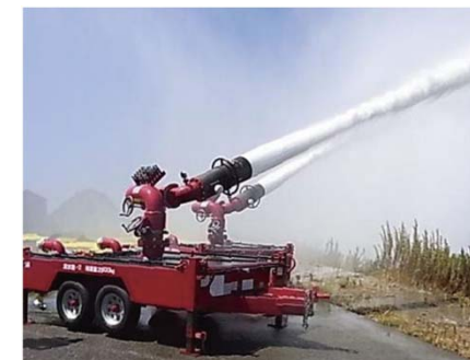
大容量泡放射システムによる放水訓練 （大阪・和歌山広域共同防災協議会）
